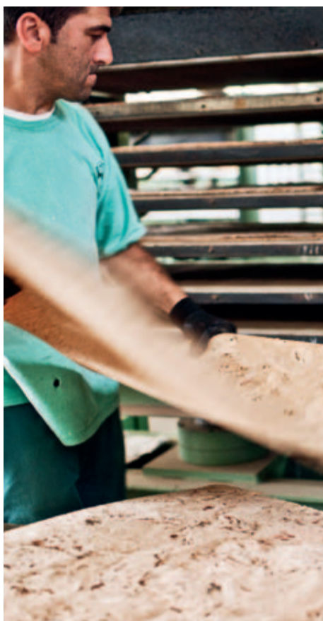
Behutsam wird die Kork-Deckschicht aufgebracht
